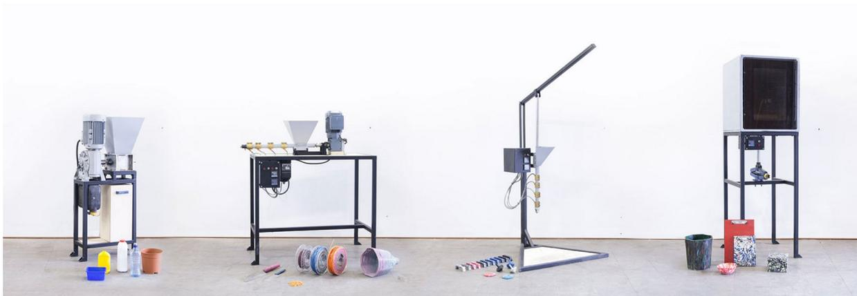
1- **La broyeuse** est un élément clé pour faire tourner l'espace de travail Precious Plastic. La broyeuse permet de découper des morceaux de plastiques en pastilles qui sont plus faciles à stocker, nettoyer et introduire dans les machines. Les industries plastiques achètent le plastique broyé 8 à 10 fois plus cher que le plastique non-broyé ; rendant la broyeuse particulièrement importante si on souhaite leur revendre du plastique.
