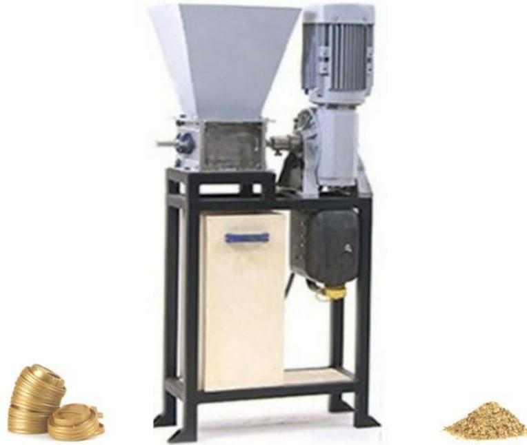
Le broyeur écrase et découpe le plastique recyclé en petits fragments en fonction du maillage choisi. Cela prépare le plastique pour le processus de fusion.
