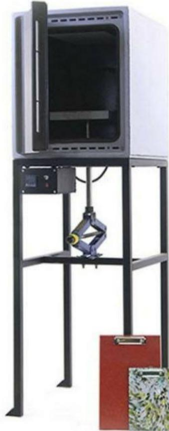
La compression fait fondre les plastiques dans le four et les compresse avec un cric de voiture. Nous pouvons fabriquer de nombreux produits tels que des planches, des contenants et des blocs de matières premières.
